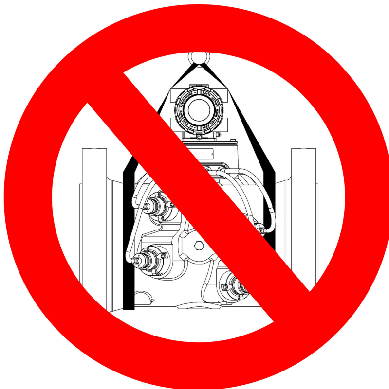
图 2-16: 错误的吊索连接
